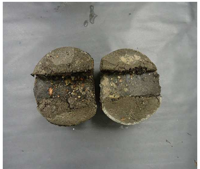
(d) Failed sample( rut depth>20mm)
